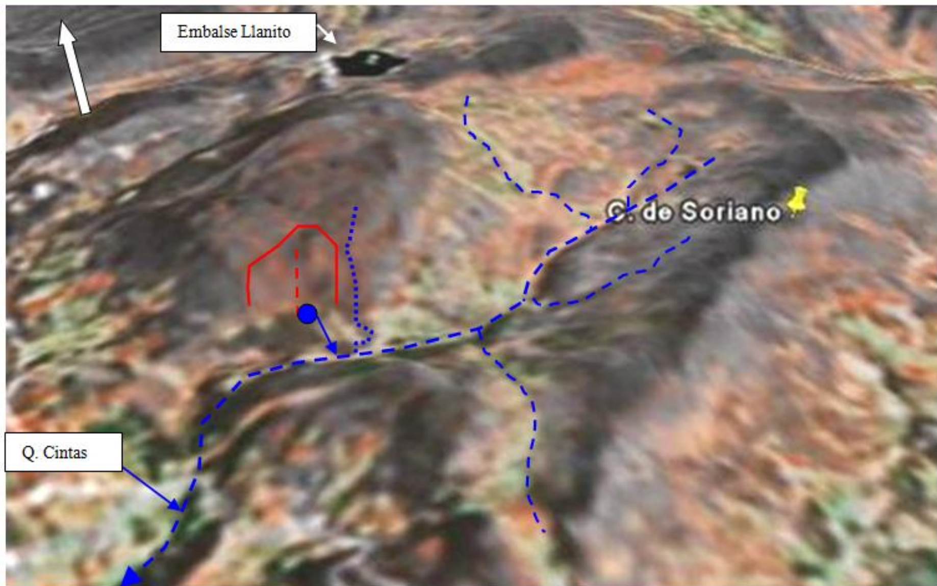
Figura 13: Imagen satelital donde se muestra la red hidrogrfica de la quebrada Las Cintas (lnea azul entrecortada), la zona de recarga del nacimiento (lnea roja continua), las fracturas del macizo rocoso (lneas roja intermitente y azul punteada). Del nacimiento (punto azul) se drena agua hacia la quebrada las cintas (flecha azul).
